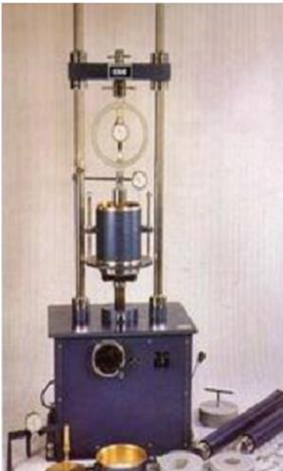
Fig: 3.20 CBR Testing
