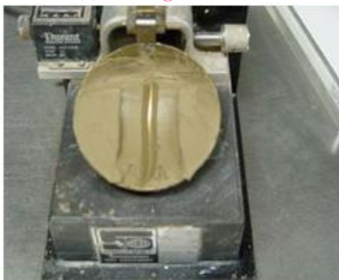
(d) Soil pat after test
