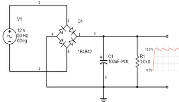
Figure 5: RC-Filter Rectifier
