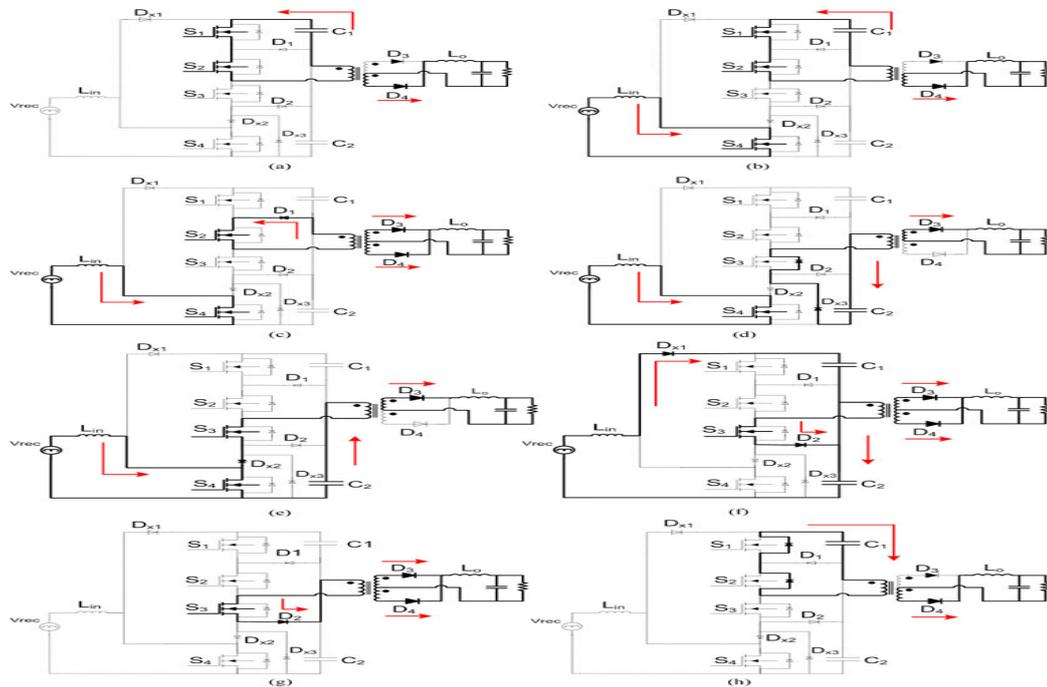
Fig. 3. Equivalent circuits for each operation stage for the converter. (a) Mode 1( $t_0 < t < t_1$ ). (b) Mode 2( $t_1 < t < t_2$ ). (c) Mode 3( $t_2 < t < t_3$ ). (d) Mode 4( $t_3 < t < t_4$ ). (e) Mode 5( $t_4 < t < t_5$ ). (f) Mode 6( $t_5 < t < t_6$ ). (g) Mode 7( $t_6 < t < t_7$ ). (h) Mode 8 ( $t_7 < t < t_8$ )
