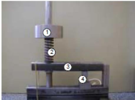
Fig. 11. Test rig for experiment 1) Mass 2) Spring 3) Lever 4) Piezoelectric Stack
