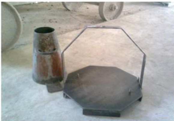
Fig. Slump test apparatus
