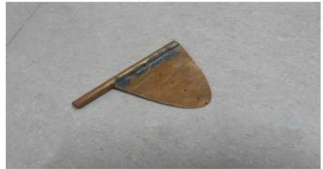
Copper parabolic fins
